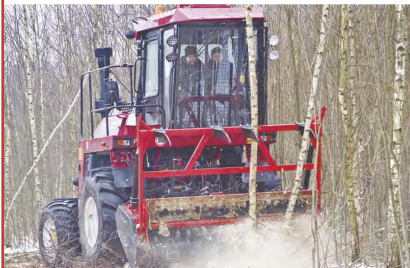
Испытание мульчера в Калужской МТС.
