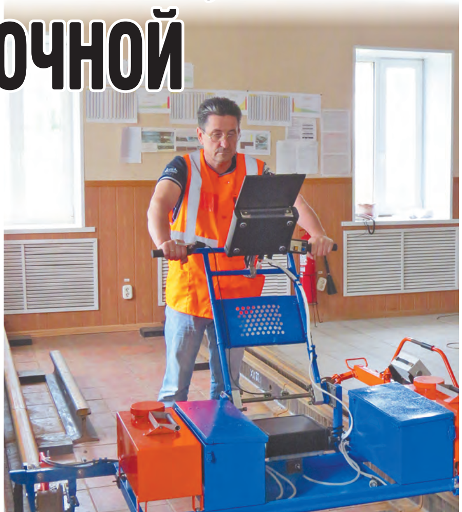
Юрий Кузинский занимается проверкой параметров дефектоскопной тележки.
